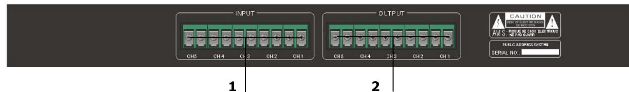
**1. КЛЕММЫ INPUT** – Входы 100 В от усилителя.
